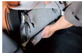
04 背面に回っての作業。カバー左右にあるファスナーを開いて先ほど隙間に差し込んだカバー下部をしっかりと引っ張り出す。
